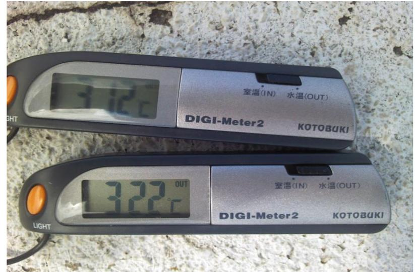
温度計の拡大写真。向かって上が未施工側スタート温度。下がフィルム施工済側スタート温度です
